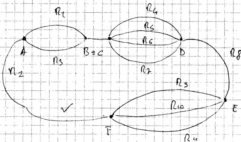
$$R_{EQ} = (R_2 // R_3) + R_1 + (R_4 // (R_5 // R_6 // R_7)) + R_8 + (R_9 // (R_{10} // R_{11}))$$
